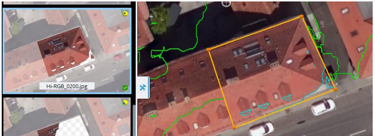
图1 绿线是正射影像镶嵌的当前接缝线。青线是在多边形内部应用选定影像时将引入的新接缝线。
